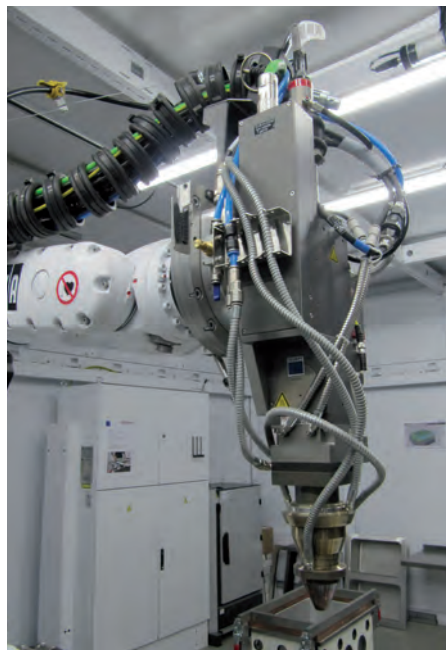
De laskop van Groku Kampen. Deze kop heeft een motorisch gestuurde spotgrootte. Onder de nozzle voor het toevoeren van het schermgas
