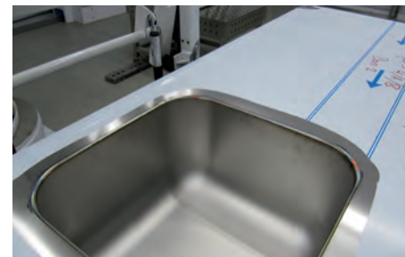
De spoelbak en de plaat samengelast na het openen van de lasmal
