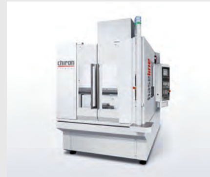
FZ 15W Baseline. Dit is een HSK 63 productiebewerkingscentrum met een machinebereik van 550 mm x 400 mm x 425 mm (X x Y x Z) die met een korf- of pick-upwisselaar met een Siemens 840D sl leverbaar is (foto: Chiron)
