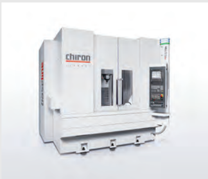
Mill FX 800 Baseline. Een vijffasser met een HSK 63 opname. Machinebereik over X-, Y- en Z-as is respectievelijk 800 mm x 630 mm x 550 mm. Verkrijgbaar met Siemens 840D sl of Heidenhain iTNC 530 (foto: Chiron)
