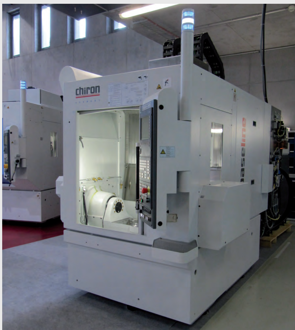
Een vijfassige FZ12 FX Baseline in de demonstratieruimte van Chiron in Tuttlingen (D). De Baseline machines zijn herkenbaar aan de witte deuren (foto: Reinold Tomberg)
