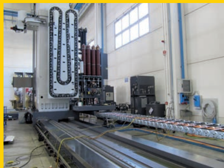
Een Spirit frees- en kotterbank in opbouw. De accu's zijn voor de rambalancering
