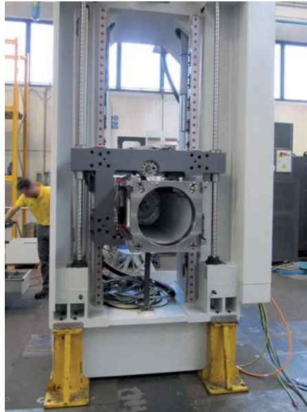
'Box-in-box'-bouwwijze van FPT. Zadel en ram zijn opgenomen in de machinekolom en niet zijdelings naast de kolom
