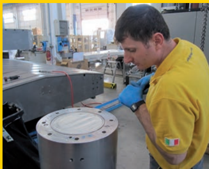
Schrapen van een machineonderdeel bij FPT. Schrapen is en blijft een mooi ambacht
