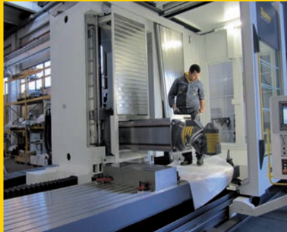
Tessen blokbedreesmachine met universele kop, klemming onder elke hoek met Hirth-vertanding
