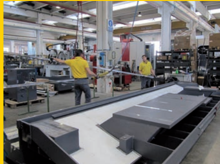
Montage van rollengeleidingen voor een Tessen blokbedreesmachine
