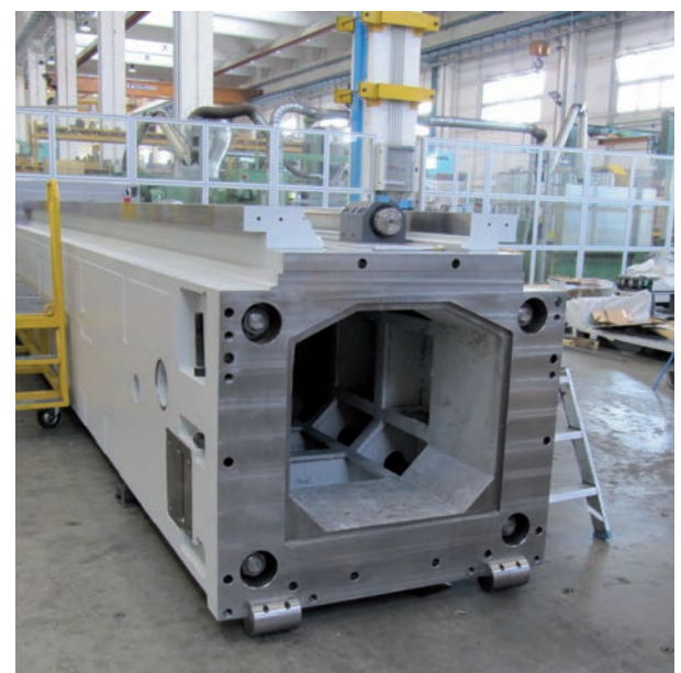
Vier trekstangen in een machinekolom van FPT. Door actief te 'spelen' met de voorspanning op deze stangen zijn machinevervormingen te compenseren
