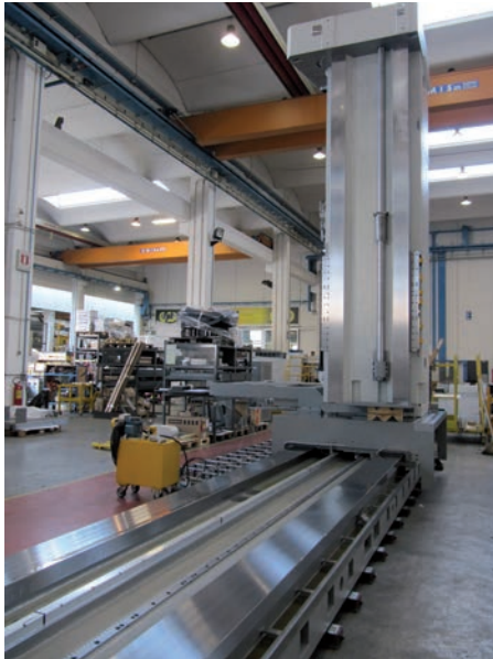
Een Spirit frees- en kotterbank met hydrostatische geleidingen in opbouw bij FPT in S. Maria di Sala.
