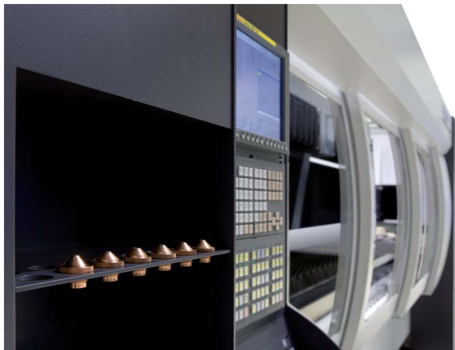
Nozzle-wisseling is een onderwerp dat momenteel bij het lasersnijden veel aandacht krijgt. Deze machine van LVD is voorzien van een Fanuc-laserbron (foto: LVD)
