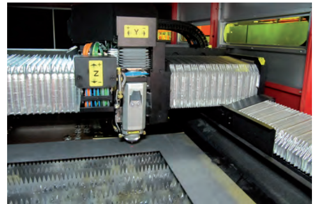
Een kijkje in de Amada lasersnijmachine FOL-3015 AJ. Dit is een vlakbedsnijlaser die werkt met een plaatformaat van maximaal 3.000 mm x 1.500 mm
