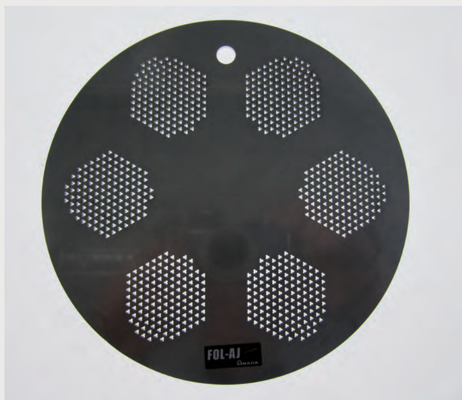
Een proefwerkstuk dat de mogelijkheden voor (fijn)snijden van de Amada lasersnijmachine FOL-3015 AJ illustreert. De talloze gaatjes in de zes segmenten in deze 2 mm dikke plaat van rvs 304 zijn opgebouwd uit drie elkaar overlappende cirkels met een diameter van 0,8 mm. De hoekjes zijn scherp gebleven, een teken hoe goed het snijproces beheerst wordt. De totale snijtijd bedraagt 35 min en 53 s (foto's: Reinold Tomberg)
