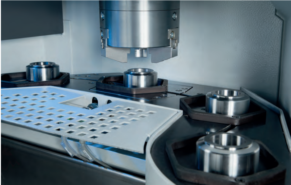
Beide hoofdspillen kunnen als een 'pick up'-spil werkstukken laden en lossen in transportprisma's van een kettingtransporteur. Door middel van een omkeerinrichting kunnen de werkstukken omgedraaid worden (foto: Emag)
