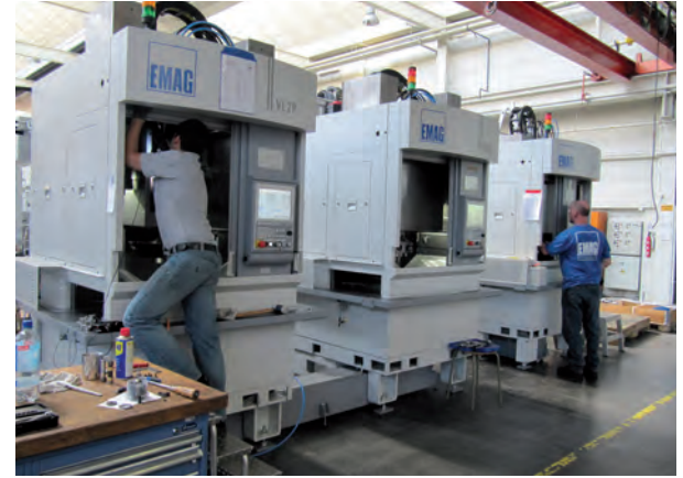
Een drietal verticale draaicentra van het type VL 2P in opbouw bij Emag in Salach (D). Het zijn machines met een frame van polymerebeton (foto: Reinold Tomberg)
