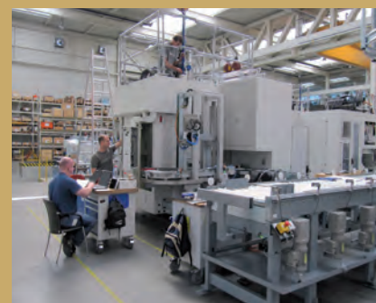
Opbouw van een VTC machine voor asbewerkingen
