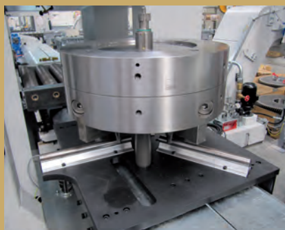
Station voor het wisselen van een grote klauwplaat
