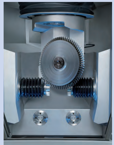
Een kijkje in een Emag PO 900 BF die een blik bewerkt voor een aerospace-toepassing
