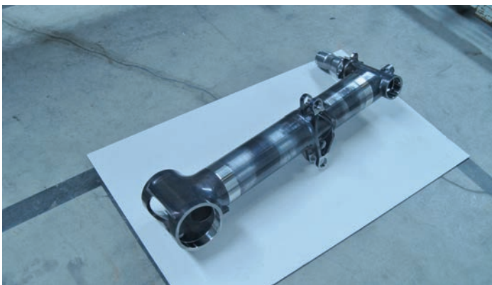
Een kenmerkend complex onderdeel voor een landingsgestel, zoals dat bij Fokker LG wordt vervaardigd uit volmetaal op het M65 draaifreescentrum in slechts twee opspanningen (foto's: Leon de Schepper)
