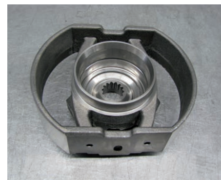
Een rotor voor een slangenpomp zoals die bij Bredel wordt bewerkt op de M65. Omdat het product in een enkele opspanning compleet kan worden bewerkt is de totale doorlooptijd teruggebracht van vijf weken naar nog slechts 28 minuten (foto: Jan Oonk)
