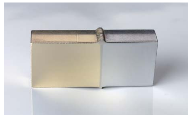
Figuur 5. Voorbeelden van EB-lasverbindingen in aluminium (diepte 150 mm) en in een verbinding tussen staal en brons (diepte 30 mm)
