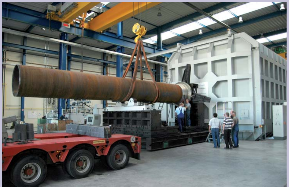
Figuur 1. Een met de elektronenbundel gelast groot onderdeel. Op de achtergrond staat de immense vacuümkamer van de elektronenbundellasinstallatie (foto's: Pro-beam)
