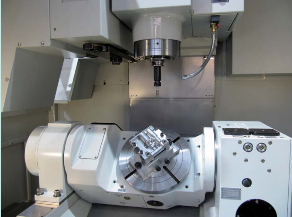
Het vijf-assige bewerkingscentrum Quaser MF400 werd in Stuttgart aangeboden met een actieprijs van 89.900 euro. De foto toont een blik in de bewerkingsruimte van deze machine met een bereik van 410 mm x 610 mm x 510 mm (X x Y x Z)
