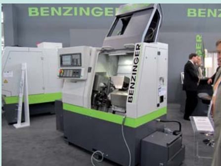
De precisiedraibank DoLittle van Benzinger. Deze machine wordt geleverd als éénspilmaschine of met tegenspil voor compleetbewerken
