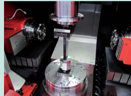
Amada toonde de dubbelspilfreesmchine THV 430 voor het eerst in Europa. Dit is een machine waarmee bijvoorbeeld loonzagerijen blokken metaal tweezijdig aan de maat kunnen frezen. Op de foto links en rechts spullen met vlakfrezen. Een neerhouder drukt het werkstuk vast. De tafel kan indexeren om schuine kanten aan de blokken te kunnen frezen
