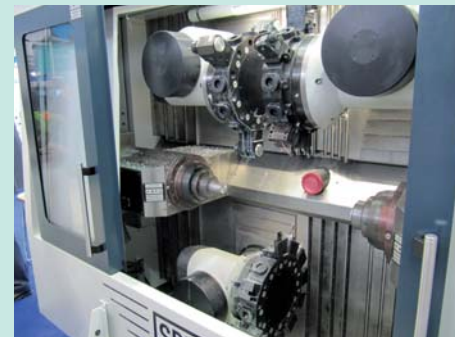
Een mooie opstelling met drie revolvers en twee spullen bij de Spiner TD 42 - Triplex. Op de beurs hing aan deze machine een prijskaartje met een vanafprijs van 185.000 euro. Deze machine heeft een maximale stangdoorlaat van 42 mm
