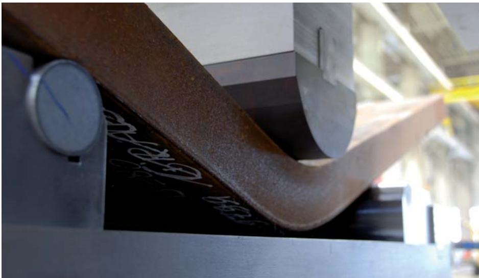
Door toepassing van een klantspecifieke hydrauliekunit en besturing kan de machine plaatmateriaal tot een dikte van 150 mm buigen
