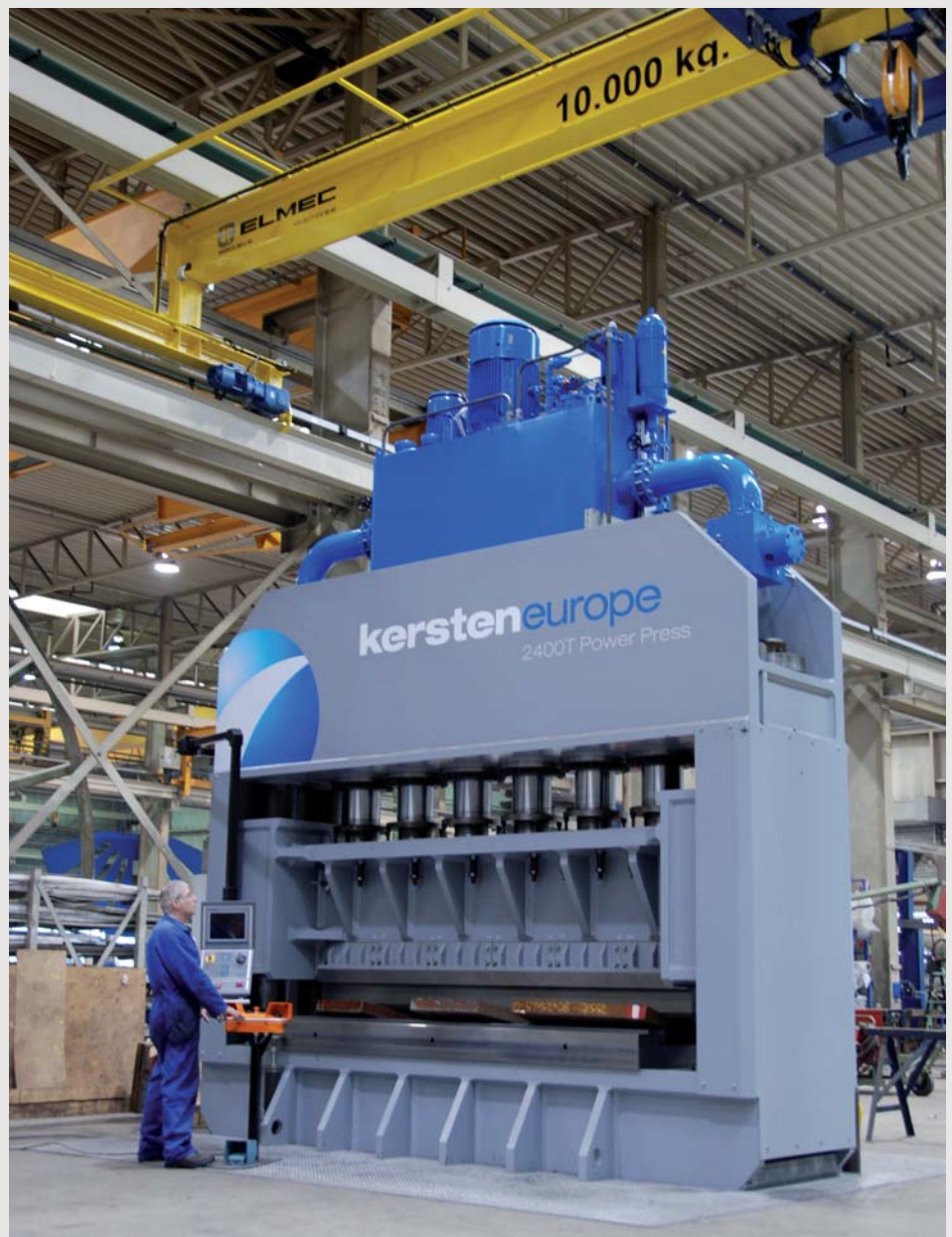
De nieuwste machine bij Kersten Europe is volledig in eigen beheer opgebouwd om (nog) dikker plaatmateriaal te kunnen buigen voor onder andere de windenergie- en offshore sector (foto's: Kersten/Bosch Rexroth)
