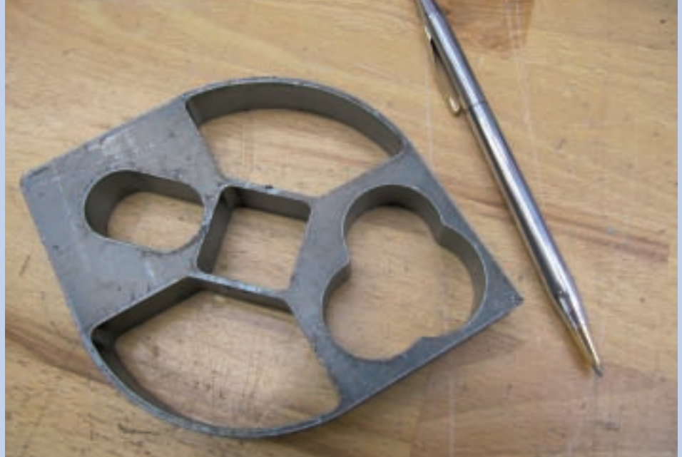
Een voorbeeld van dikwandig lasersnijwerk van plaatstaal met verrassend fijne snijstructuur. Het wandje dat blijft staan is relatief dun (in vergelijking met de plaatdikte) en heeft een goed oppervlak (foto's: Reinold Tomberg)
