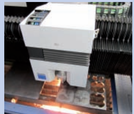
Lasersnijden met een 6 kW CO 2 -laser met waterkoeling. De plaat wordt iets vochtig
