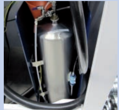
De tank met demi-water met een inhoud van 20 liter ingebouwd in de Trulaser 3030
