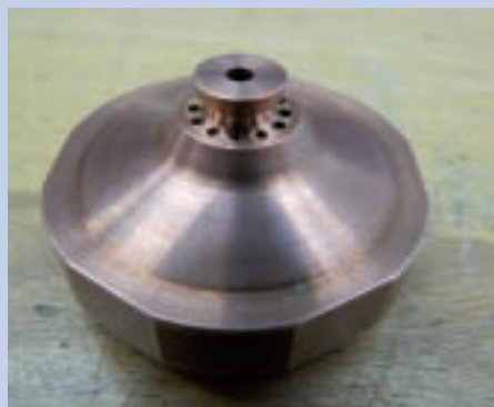
De nozzle van de 6 kW vlakbedlasersnijmachine van Trumpf. In het midden de extra boringen voor de waterkoeling
