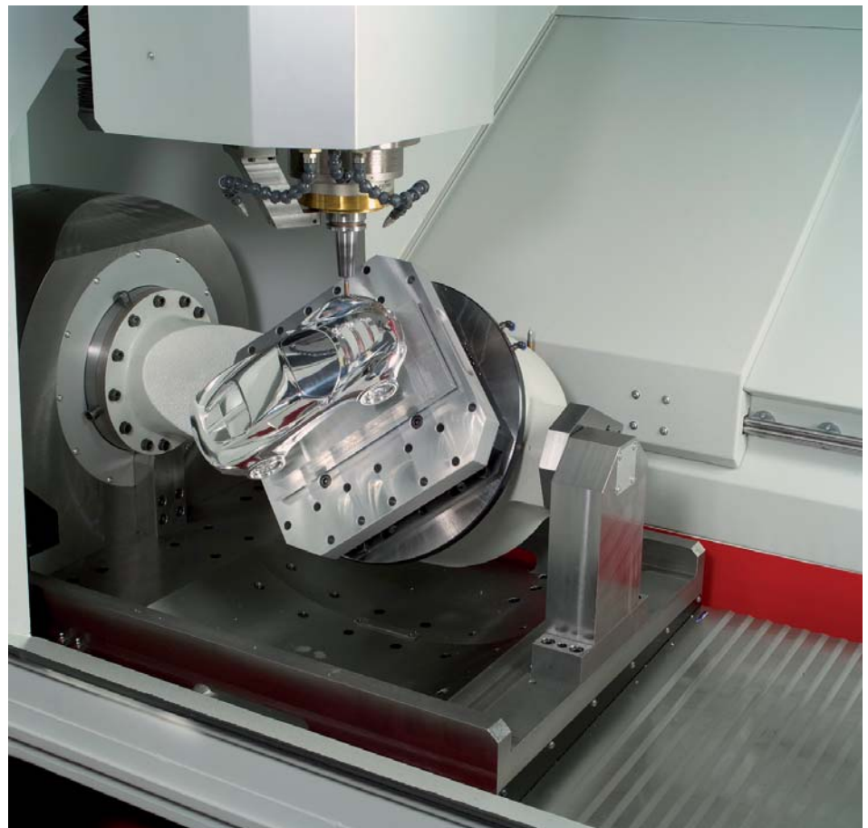
Vijfassig bewerken van een model op een hogesnelheidsmachine. Deze machine wordt ook ingezet voor hardverspanen (foto: Röders)
