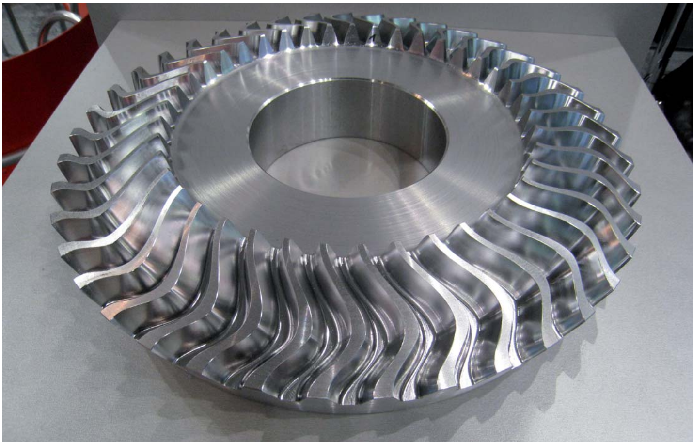
Een mooi voorbeeld van eigentijds vijfassig werk: een 'onmogelijke' vertanding gefreesd op een Hermle bewerkingscentrum (foto: Reinold Tomberg)
