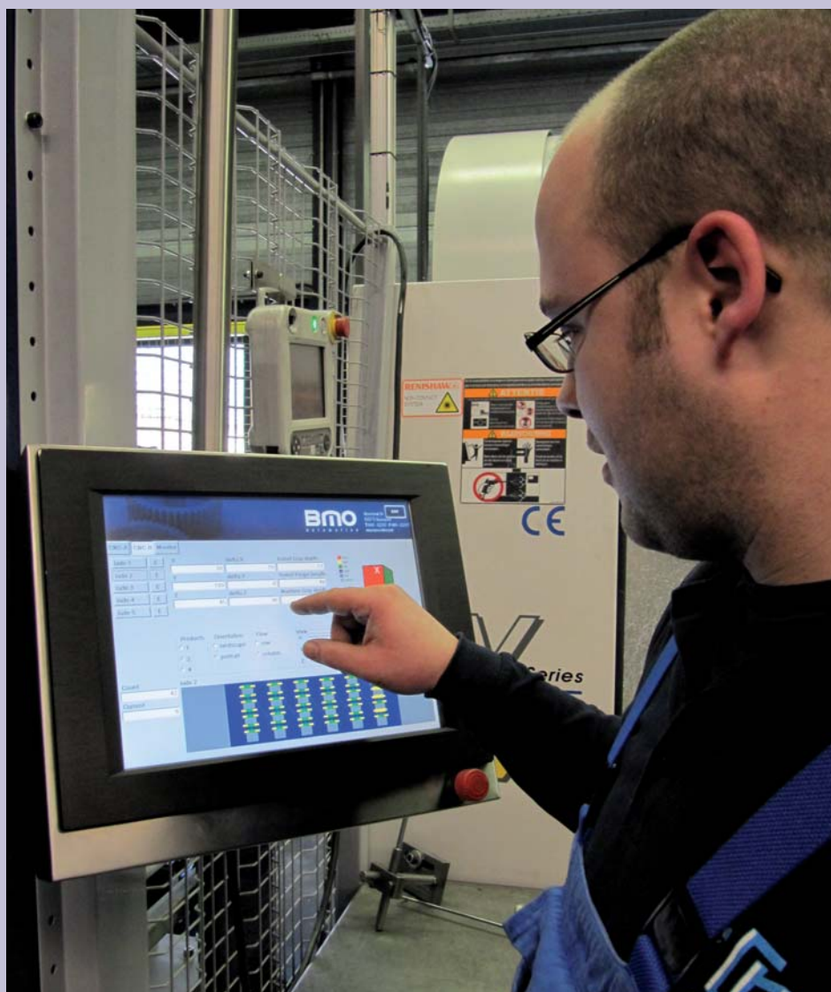
Los van de beide CNC-besturingen van de YCM bewerkingscentra heeft de Proloader een eigen, eenvoudig te bedienen besturing. Ingave van materiaalafmetingen, aantallen en positie is voldoende om aan de slag te gaan. De robot geeft de 'aftrap' aan de bewerkingscentra (foto's: Reinold Tomberg)
