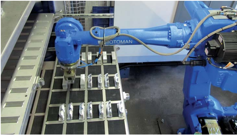
De robot bezig met laden en lossen in een schuiflade. In het midden van de lade de opname waarmee de robot de lade kan openen en sluiten. Op de lade het lasergesneden raster voor de positionering van materiaal en werkstukken
