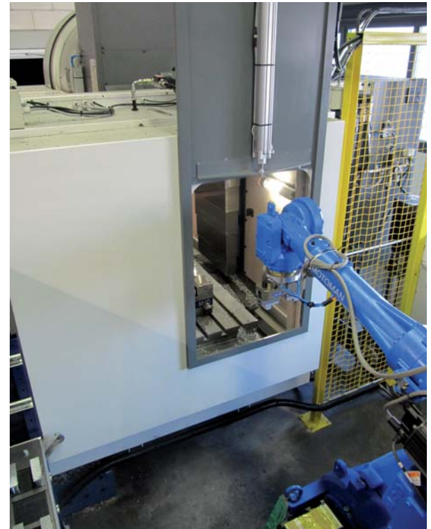
Van belang is dat de robot de beide machines laadt en lost via een deur aan de zijkant. De voorzijde van beide machines blijft dus goed bereikbaar
