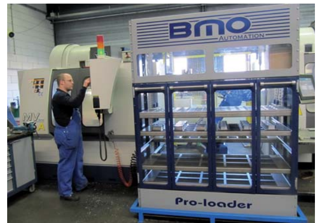
De Proloader van BMO Automation is door Promas geleverd aan MCM in Liessel. Achter de vijf schuifladen staat de Motoman robot opgesteld tussen de twee bewerkingscentra. Promas heeft de Proloader geplaatst, de software-aanpassingen aan de machines verzorgd en de Proloader in bedrijf genomen
