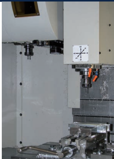
De spindel is direct gekoppeld aan de aandrijfmotor, wat resulteert in minder trillingen. Vier hoekcontactlagers zorgen ervoor dat zowel radiale als axiale krachten kunnen worden opgenomen (foto: Jan Oonk)
