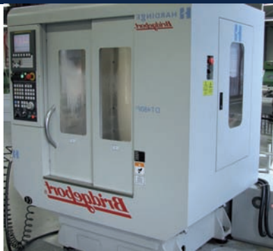
Compact, robuust en dynamisch: enkele trefwoorden van de twee nieuwe GX 480TD-bewerkingscentra bij FTU (foto: Jan Oonk)
