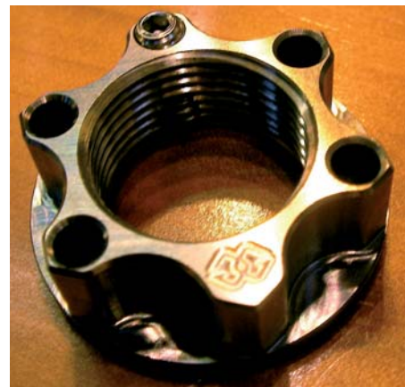
Een titaan-moer voor de achteras van een motorfiets van de legering Ti6AlV4, met een eigen massa van maar 20 g. Dit onderdeel wordt op het internet aangeboden met een prijs van 50 pond sterling (bron: www.superbike.co.uk )
