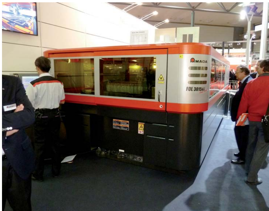
De fiberlaser die Amada tijdens de EuroBlech 2010 in Hannover presenteerde. Dit is een lasersnijmachine met een vermogen van 4 kW (foto: Paul Quaedvlieg)
