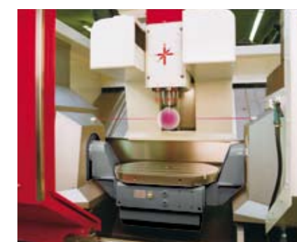
Eingebaute Laserlichtschranken zur hochpräzisen Werkzeugvermessung und Werkzeugbrucherkennung
