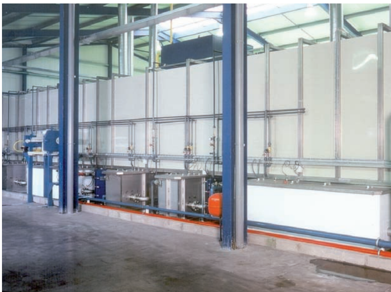
Een deel van de natlaklijn waarin met succes warmtekrachtkoppeling is toegepast (foto: Belmeko)
