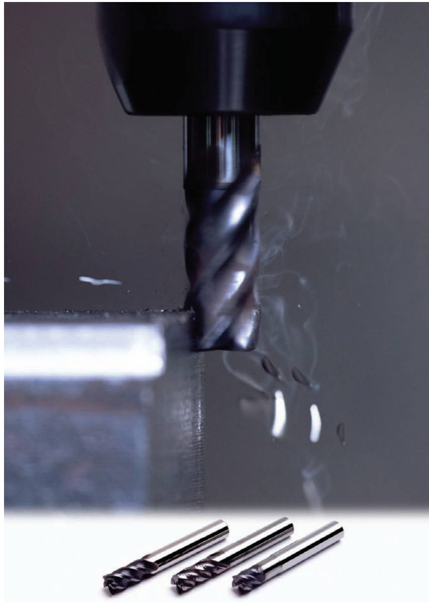
Met de HPM-frezen zijn we volgens Seco Tools teruggekeerd naar het basisobjectief van het frezen, namelijk tegen de laagst mogelijke kosten een maximum productiviteit (foto's: Seco Tools)
