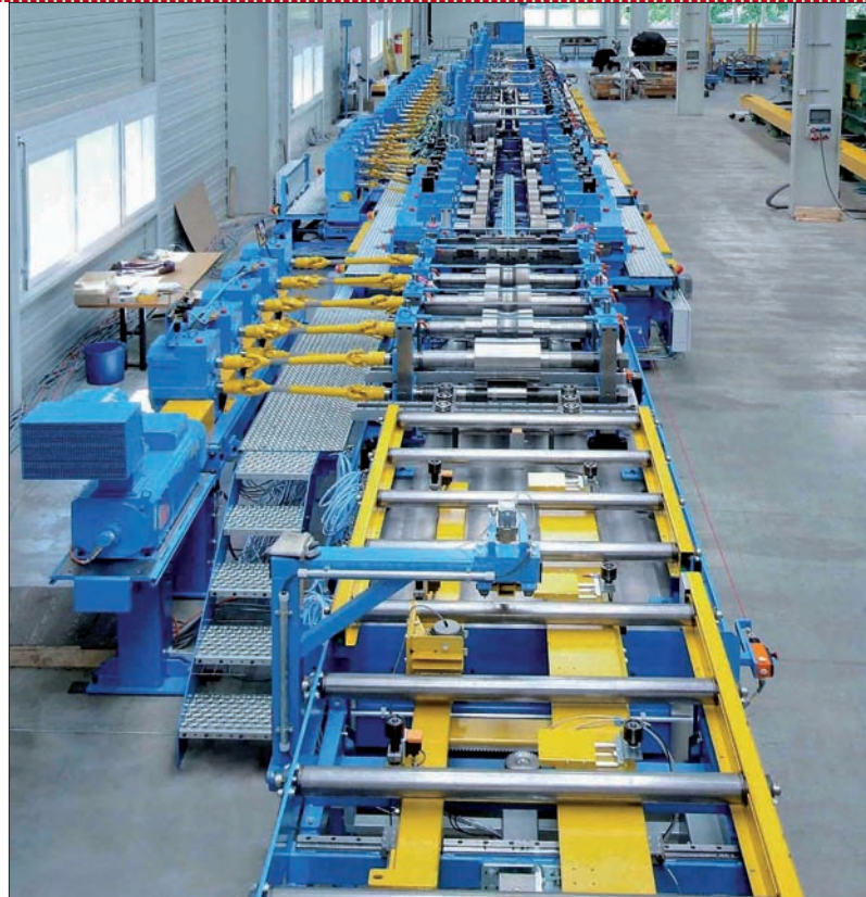
Een overzicht van de machine van MRP. De machine bestaat uit vier afzonderlijk machines met een totale lengte van ongeveer 40 m
