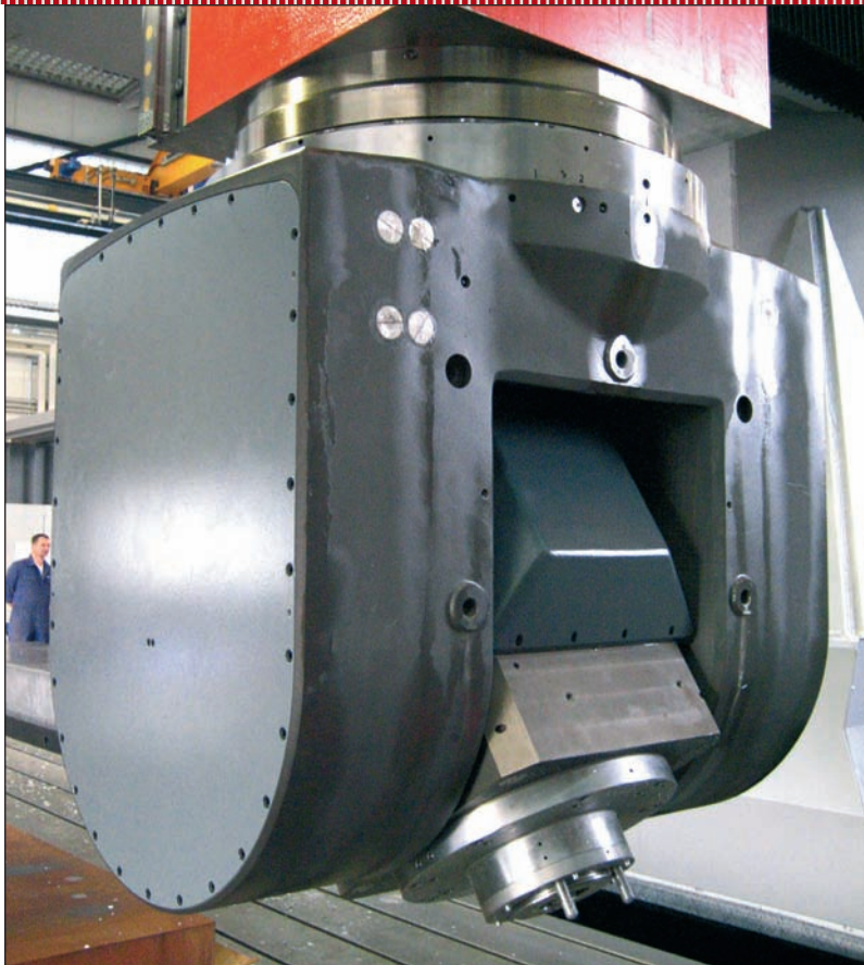
De A- en C-as van de freeskop van de 50 P hebben een directe 'Torque'-aandrijving. Dit reduceert de omkeerspelingen en verbetert dus het gefreesde oppervlak. Bereik A- en C-as is respectievelijk \pm 120^\circ en \pm 200^\circ
