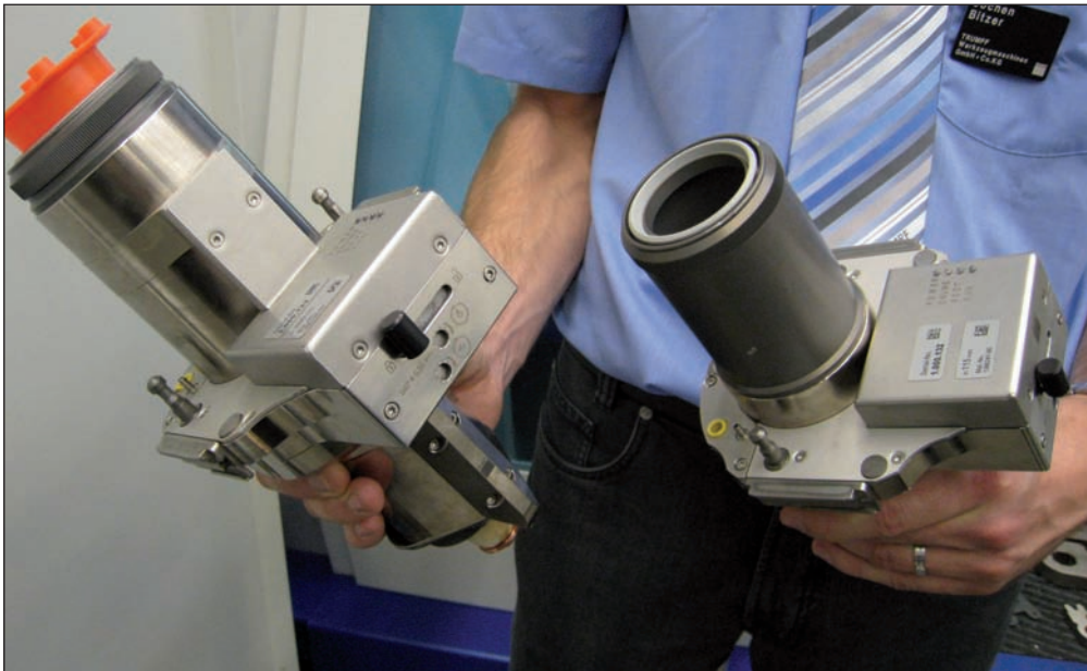
Twee snijkoppen van Trumpf gebouwd volgens de éénkopsstrategie. De kop rechts met een brandpuntsafstand van 115 mm is een speciale hogesnelheidskop voor dun plaatwerk. Links de snijkop met een brandpuntsafstand van 250 mm (foto's: Reinold Tomberg)
