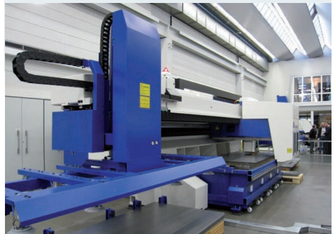
Opvallend bij de Trumpf Trulaser 2030 is het ontbreken van een wisseltafel
