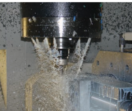
Met hoge druk koeling (maximaal 70 bar, in drie stappen instelbaar) wordt tijdens een toerental van maximaal 10 000 toeren gekoeld.
