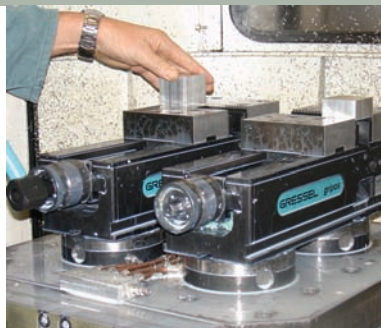
In het wisselstation worden de pallets gevuld met materiaal voor bewerking; in de machine wordt (indien nodig) via een Renishaw-meetsysteem het nulpunt bepaald
