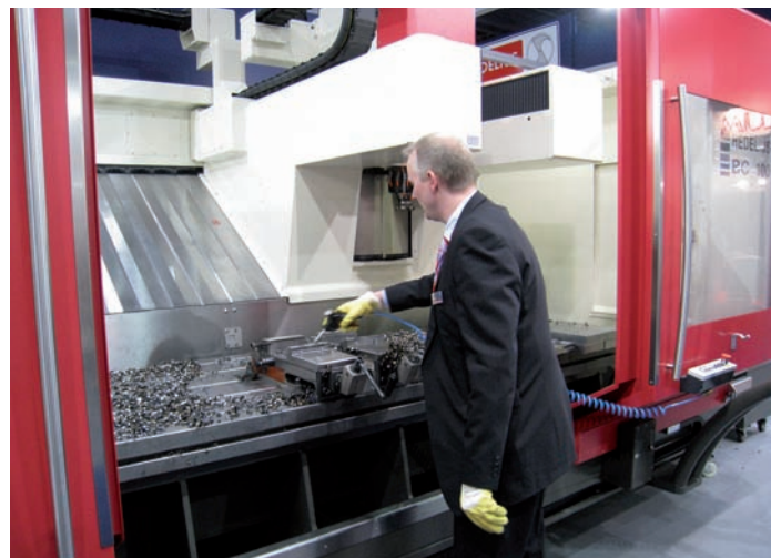
Hedelius demonstreerde tijdens de beurs het verticale pendelbewerkingscentrum BC 100/2500. De demonstratie maakte duidelijk dat zwaaverspanning met 55 kW op de hoofdspil tot de mogelijkheden behoort
