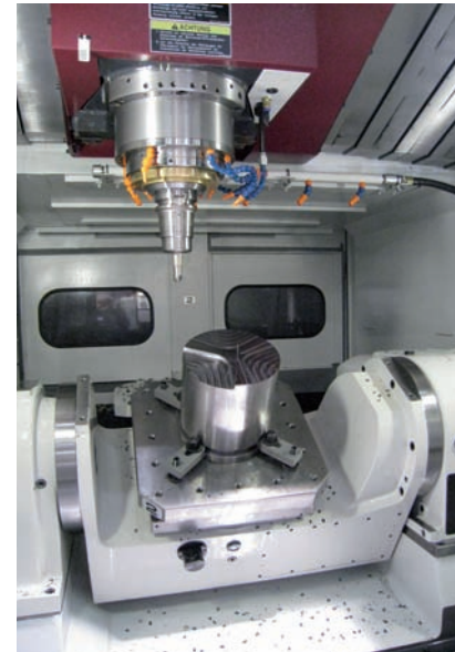
Teamtec demonstreerde het nieuwe verticale bewerkingscentrum VG 5000 van OKK. Dit is een vijf-assige machine met een BT50 Big Plus 40 kW hoofdspil met een koppel van 600 Nm
