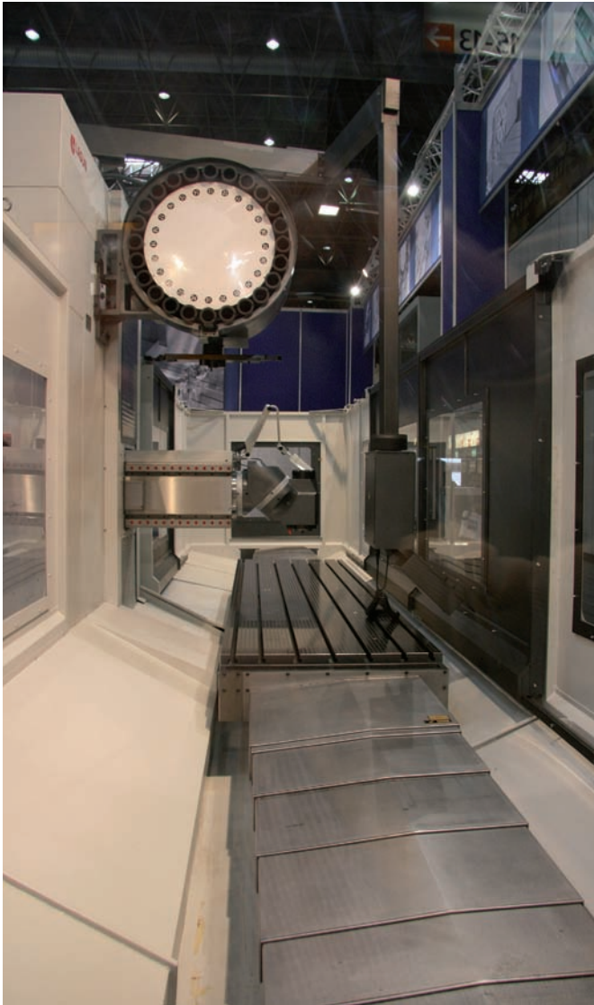
Deze Lagun G-Nova 41 bedfreesbank heeft een tafel van 4100 mm bij 1000 mm. De verplaatsing is 4000 mm (X-as), 1200 mm (Y-as) en 1500 mm (Z-as)
