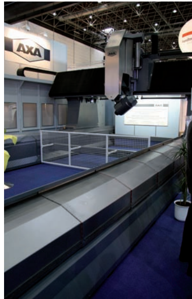
Axa toonde in Düsseldorf onder meer deze grote UPFZ portaalreesmachine met zwenkop voor een vijf-assige bewerking. Leverbaar tot maximaal 12.000 mm in de X-as en 4000 mm in de Y-as
