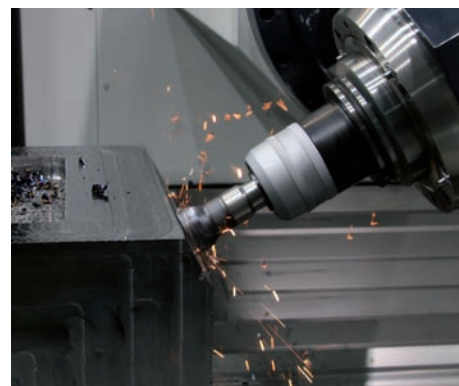
Hedelius demonstreerde tijdens de beurs het verticale pendelbewerkingscentrum BC 100/2500. De demonstratie maakte duidelijk dat zwaaverspanning met 55 kW op de hoofdspil tot de mogelijkheden behoort
