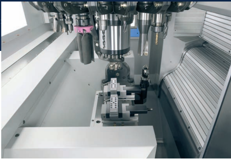
Het korfmagazijn rond de hoofdspil is bevestigd aan het machineframe en kent een eigen aansturing
