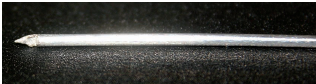
Figuur 4. Door middel van een stroomstoot aan het einde van het lassen wordt al het vloeibare metaal van de lasdraad naar het lasbad gestoten en kan de draad in de contactbuis teruggetrokken worden
