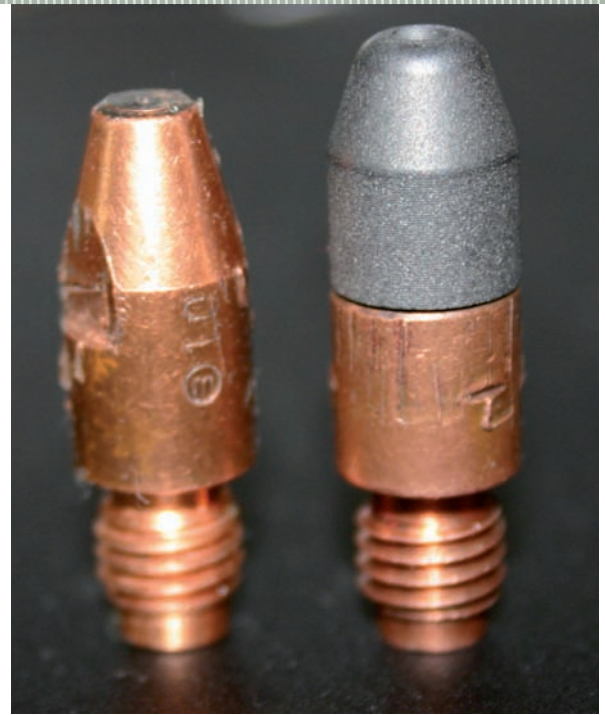
Figuur 3. Links een standaard contactbuis en rechts dezelfde contactbuis met daarop geschroefd een koolstof voorzetstuk (Carbotip). Koolstof is een redelijke stroomgeleider met een hoge smeltemperatuur. De Carbotip zal dan ook niet smelten tijdens het starten van de lasboog en kan keer op keer gebruikt worden voor een nieuwe start (foto's: W. Brabander)
