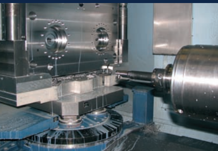
Een blik in de werkruimte van de H.Plus-630, met de horizontale spindel en op de draaibare product-tafel een brandstofinjectieblok in bewerking (foto: Jan Oonk)
