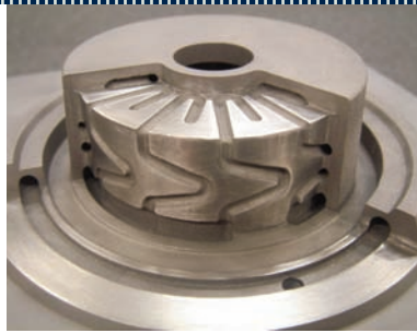
Nog een voorbeeld van een opengewerkte matrijskern met contourkoeling voor een ander product, eveneens vervaardigd met behulp van LaserCusing
