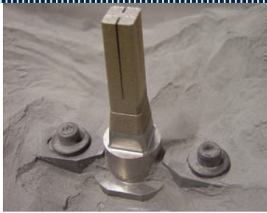
De met behulp van LaserCusing gerealiseerde kern met contourkoeling voor het spuitgieten van de vloeistofcapsules. Dankzij de geringe restporositeit bij en de hogere mechanische sterkte die daardoor resulteert, zijn via LaserCusing vervaardigde hipermoulds bij uitstek geschikt om hoge injectie- en sluitkrachten te trotseren (foto's: LaserCusing.NL)
