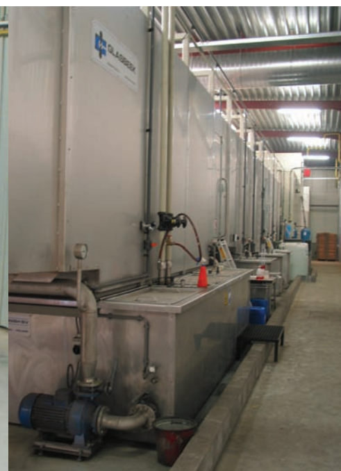
Zijaanzicht van de voorbehandeling met vooraan de ijzerfosfatering, met daarachter herkenbaar drie spoelbaden en daarachter de waterbuffer van de eigen demiwaterproductie (foto: Judith Rissewijk)
