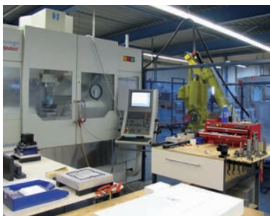
De FPC wordt gekoppeld aan een Hardinge Bridgeport machine, type VMC-5AX-500
