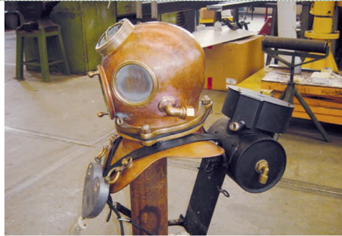
Twee opnames van een duikhelm, zoals deze werd aangeboden voor reparatie. De helm zit vol deuken en duidelijk zijn ingesoldeerde en deels geklonken inzetplaatjes zichtbaar (foto's: Rob Krul)
