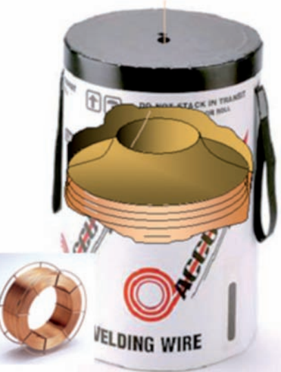
Figuur 3. Een lasdraadvoorraadvat (drum) met een massa van 250 kg of 500 kg voorzien van een uitloopconus (FlowCone) voor een probleemloze aanvoer van de lasdraad. In de inzet een standaard draadrol met een massa van 15 kg
