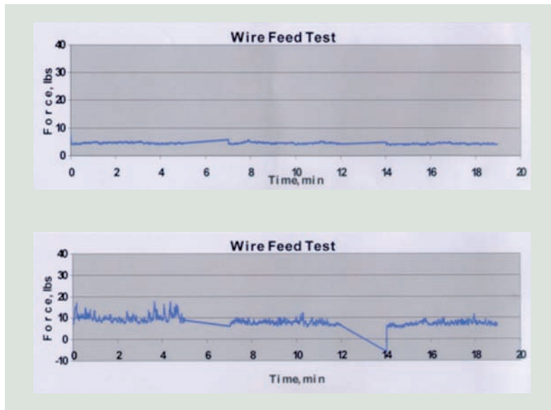
Figuur 1. Doorvoerkraft van de lasdraad in de liner als functie van de tijd voor twee lasdraden. De bovenste figuur geldt voor de speciale Lincoln lasdraad SupraMIG, de onderste figuur voor een standaard lasdraad
