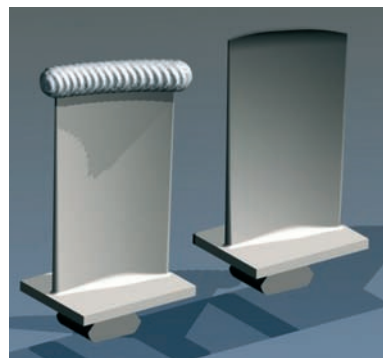
Adaptive machining wordt gebruikt om de werkelijke lasnaad te matchen met het CAM-model
