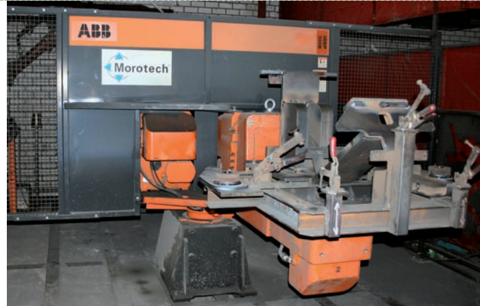
Als de robot subsamenstellingen aan het lassen is (achter scherm), kan de operator tegelijkertijd aan de voorzijde een gelast product weghalen en nieuwe componenten opspannen
