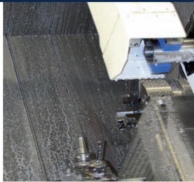
De 'part catcher' in de vorm van een gripper, neemt het gereede product uit de overnamespil (l) en legt het op een afvoerband (r). Beschadiging door een vrije val wordt op die manier voorkomen
