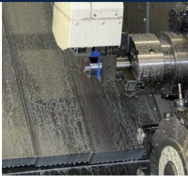
De 'part catcher' in de vorm van een gripper, neemt het gereede product uit de overnamespil (l) en legt het op een afvoerband (r). Beschadiging door een vrije val wordt op die manier voorkomen
