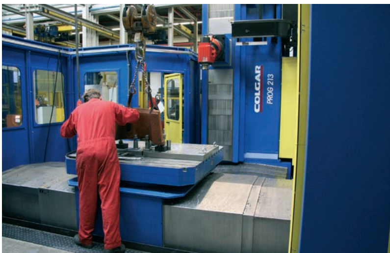
De zware werkstukken kunnen via de brede deuren eenvoudig in en uit de machine gehaald worden
