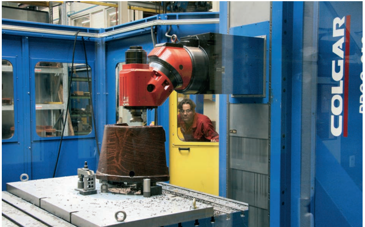
De Colgar T-type kotterbank bij Varco bewerkt voornamelijk gietstalen onderdelen met een treksterkte van 1000 N/mm 2 (foto's: Paul Quaedvlieg)
