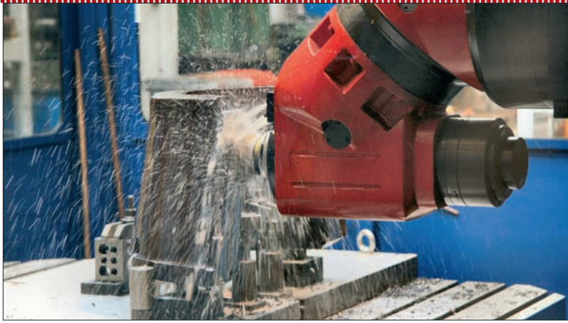
Aan de pinole werd al snel een universele Huron freeskop toegevoegd
