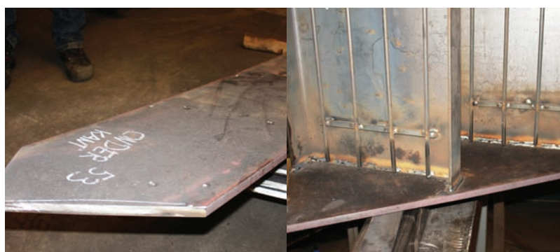
Het afteken van de vorm trap treden en de plaats op de trapboom waar de treden moeten komen
