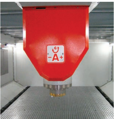
De freeskop (zonder gereedschap) van de Handtmann. Onder de vacuümspantafel voor het opspannen van het plaatmateriaal en links en rechts goten voor de spaanafvoer (foto: Reinold Tomberg)
