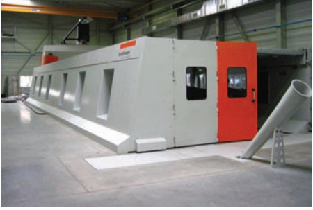
Het nieuwe Handtmann portaalbewerkingscentrum van Bayards: een machine van bijna 21 meter lang, rechts in beeld een koker voor de spaanafvoer (foto: Reinold Tomberg)
