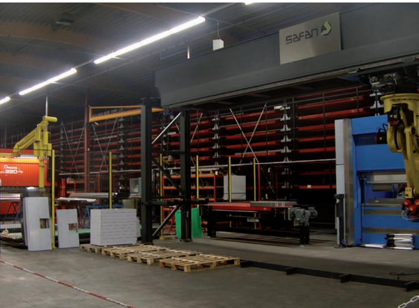
Het ruwe materiaal wordt aangevoerd vanuit een palletmagazijn met 420 posities. Links op de foto zien we een kantbank waarbij de platen 'conventioneel' worden gemanipuleerd m.b.v. een balancerarm. Rechts de Safan E-Brake met de robot die hangt aan een 9 m lang portaal
