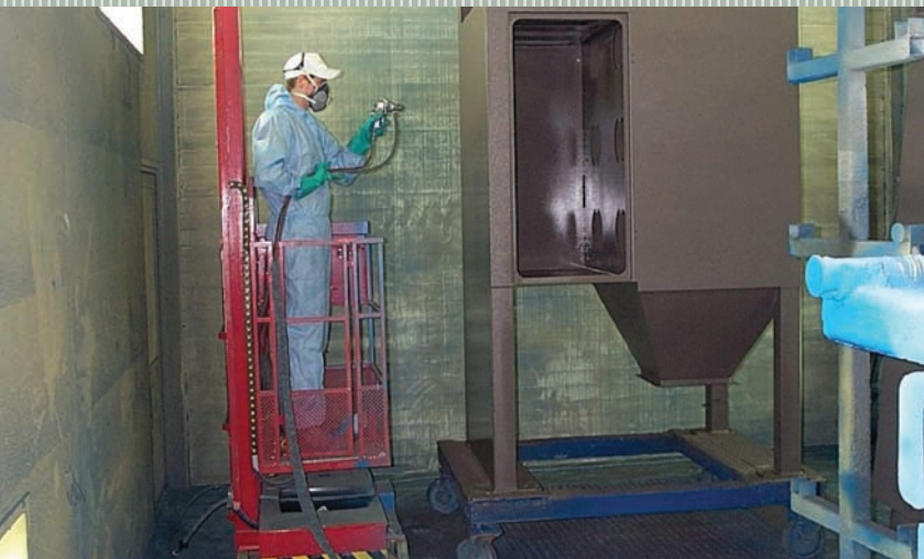
Het spuiten van de omkasting van de filterunits die maximaal 4000 mm x 2450 mm x 2100 mm groot zijn (foto: Donaldson)
