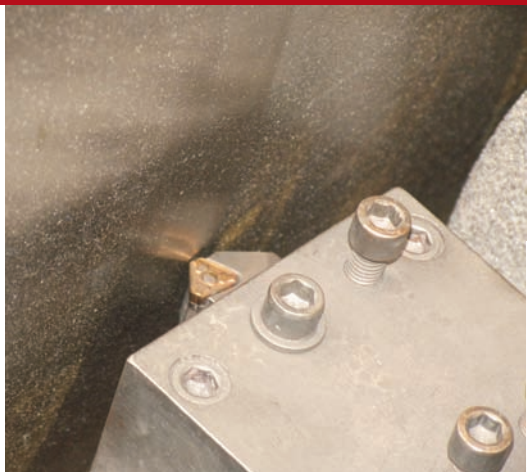
De double edge snijplaat geeft een gladder bewerkingsoppervlak
