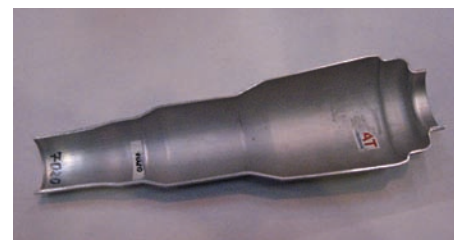
Een opengezaagd product toont de gelijkmatige wanddikteverdeling die haalbaar is met heatforming (foto: Schuler)
