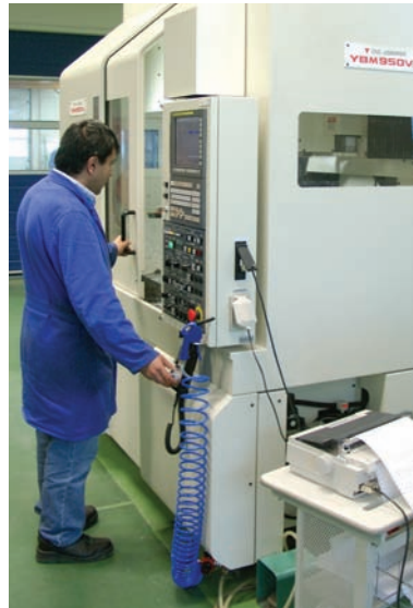
De Yasda YBM-950V bij Norma in bedrijf. Binnenkort uitgebreid met een robot om onbemand en volcontinu te produceren (foto: Jan Oonk)
