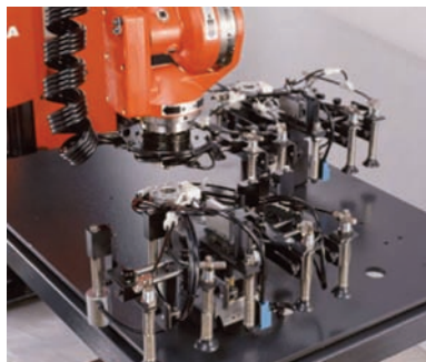
Het tableau met de vier verschillende handen voor de Astro-MP 20 robot
