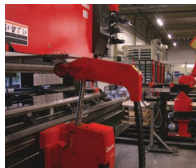
Terwijl de Astro-MP 20 robot zorgt voor het wegleggen van het product en de aanvoer van een nieuwe plaat vervolgt de buigrobot onverstoord zijn buigwerkzaamheden (foto: Jan Oonk)
