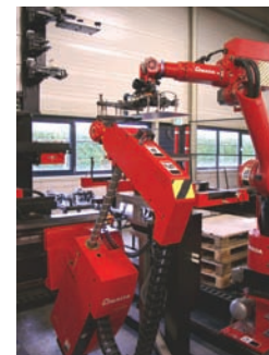
Buigrobot en Astro-MP 20 robot tijdens de omwisseling van een product (foto: Jan Oonk)
