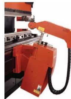
De vijfassige buigrobot is bevestigd aan en beweegt langs de onderbalk. Over de hele lengte van 3 meter kunnen meerdere buigstations worden benut
