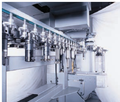
Het gereedschappenmagazijn kan op de DMC/DMU-machines in stappen van 60 posities worden uitgebreid. Met een spaan-tot-spaan tijd vanaf 4,5 s bij de duoBlock-uitvoering en vanaf 13,5 s bij de portaaluitvoering (foto: DMG Benelux)
