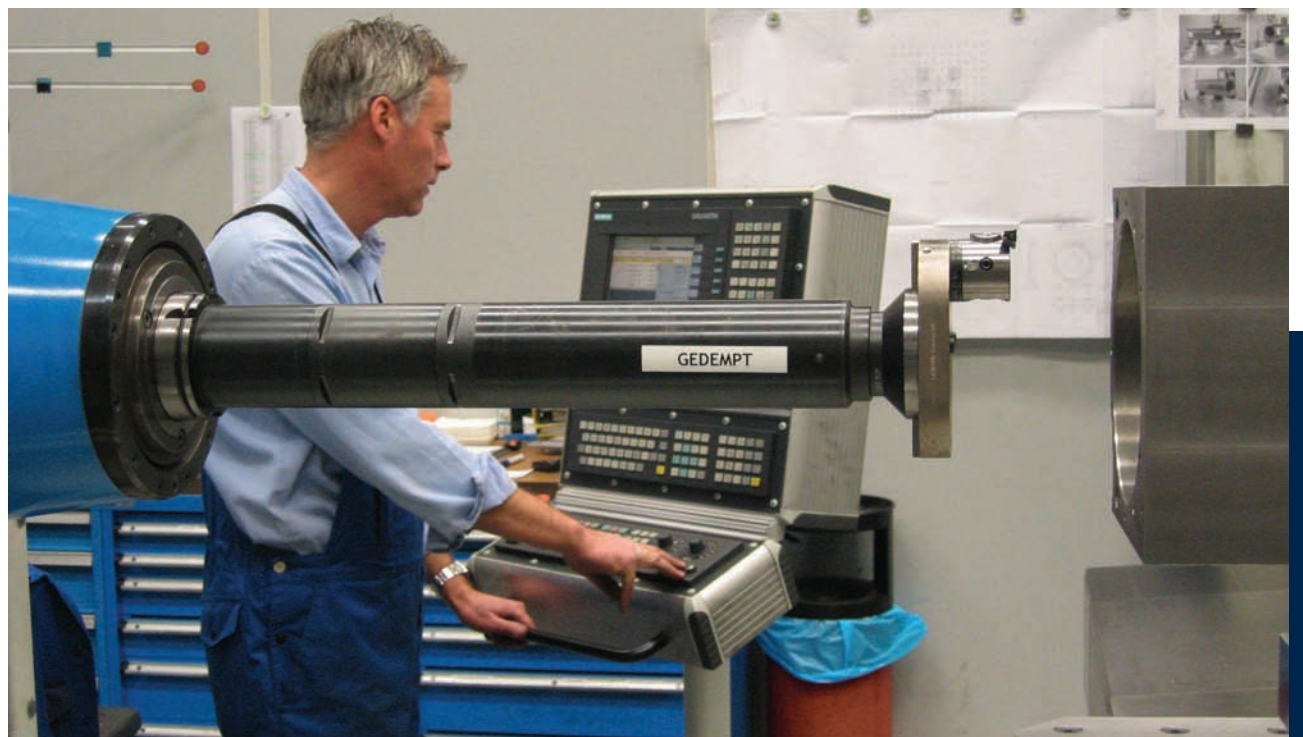
De trillingsgedempte kotterbaar wordt het werkstuk ingevoerd voor bewerking
