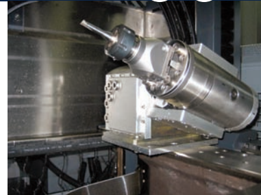
Alle draad- en zinkvonkmachines van Sodick kunnen als optie worden uitgebreid met een rondtafel als extra bewegingsas (foto: Sodick)
