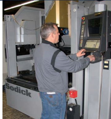
De AQ55L-zinkvonkmachine bij Gerimex, met automatische elektrodewisseling. De machine wordt geflankeerd door een elektrodemagazijn met 32 posities, waaruit kan worden geput voor de diverse bewerkingen (foto: Jan Oonk)
