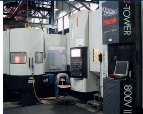
De iets kleinere Integrex e-800V II bij IHC Parts & Services; voor werkstukdiameters tot 730 mm. Eveneens uitgerust met een Pallettech-systeem met zes posities (foto: Jan Onk)
