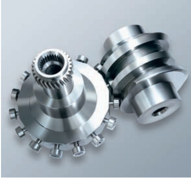
De 'roller gear cam' die verantwoordelijk is voor de beweging van de B- en C-as, zonder backlash en met een plaatsnauwkeurigheid van circa 0,0001° (foto: Mazak)
