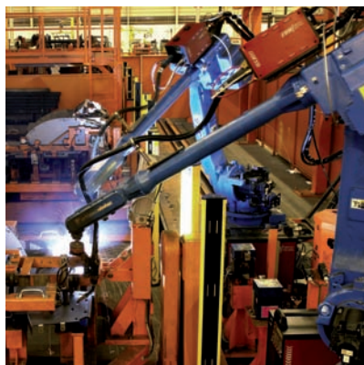
EWM Phoenix-lasstechniek in actie op dubbele Motoman-robot met een groot werkbereik van ruim 3 m (foto: Motoman)
